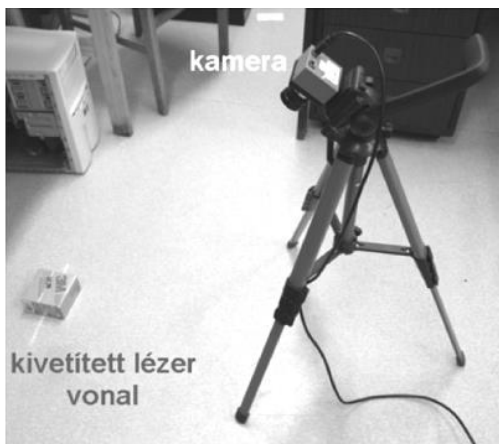
2. ábra. Ferde tengelyű kamera és a függőleges lézer által vetített vonal
