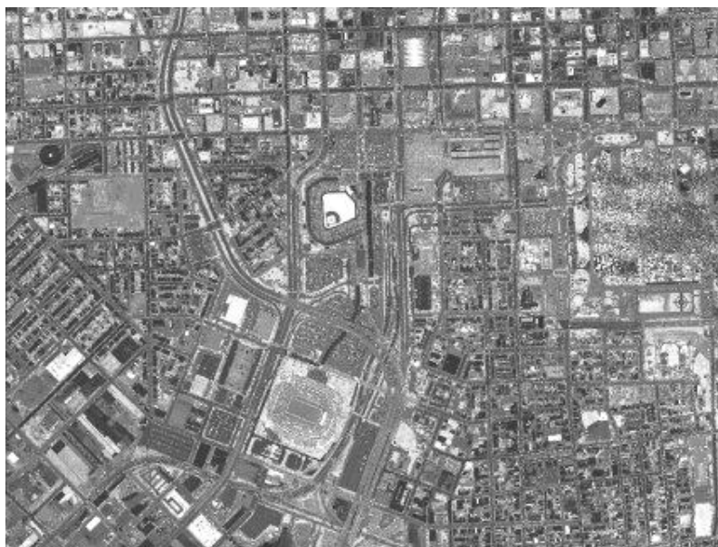
2. ábra. Légi lézerszkennelt pontfelhő intenzitás-ábrája
