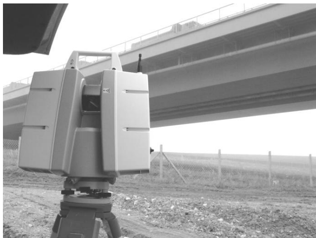
5. ábra. Szebényi M6 autópálya völgyhíd próbaterhelésének lézerszkennelése
