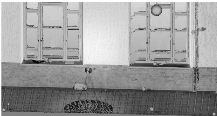
3. ábra A mérési konstelláció egy részlete a szkennert feldolgozó szoftverben
