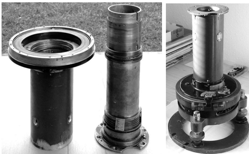
3. ábra. Az Auterbal-inga forgató középrész szétbontott állapotban és összeszerelve
