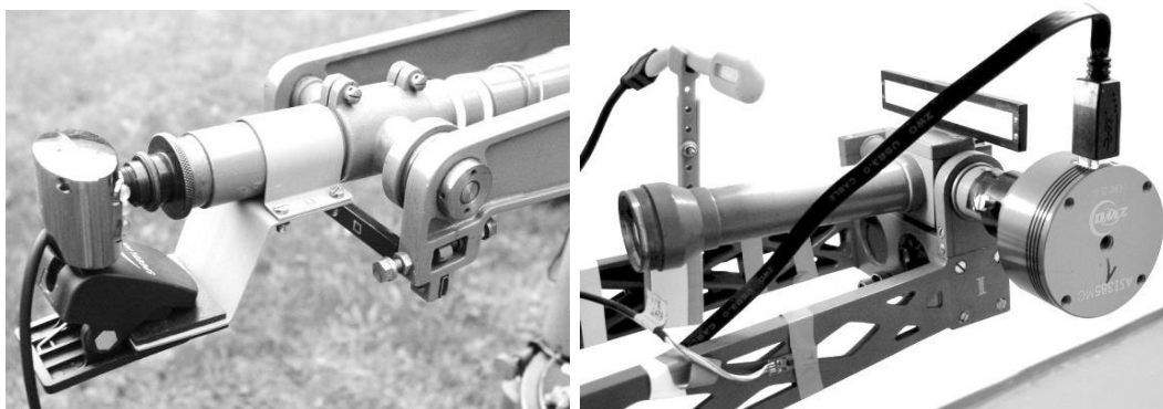
4. ábra. CCD érzékelők az Auterbal és a Pekár-inga leolvasó-karjain LED-es skálavilágítással
